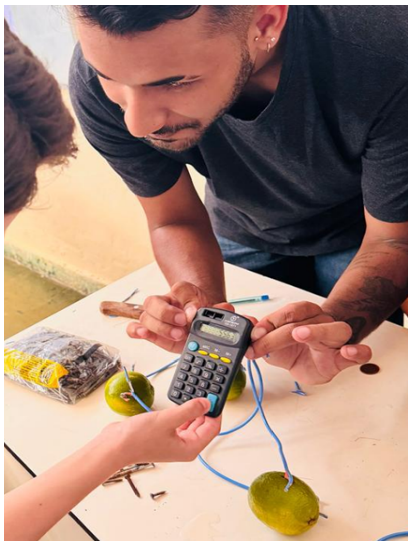
Figura 2 – Circuito Elétrico de limões.
