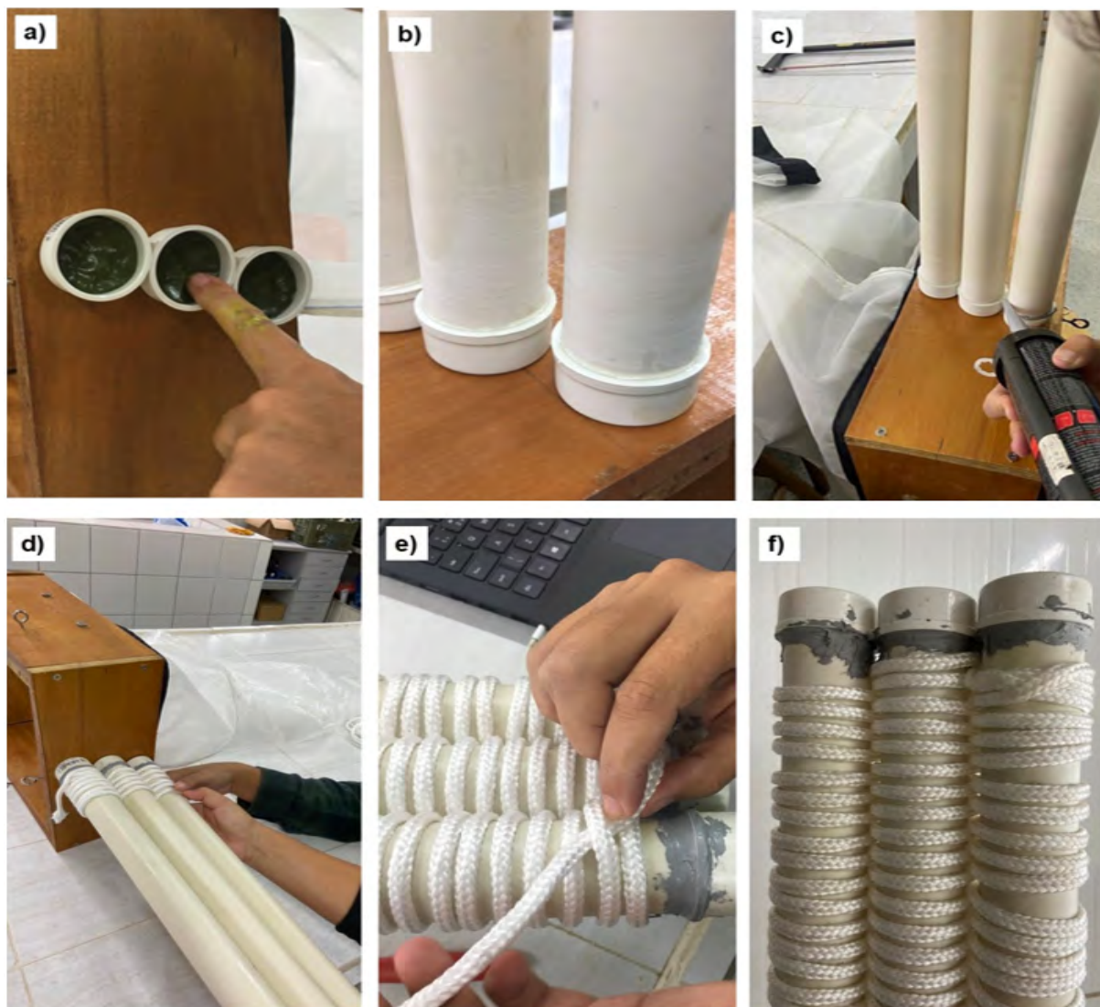
Figura 6: a) vedação dos caps com massa adesiva epóxi; b) Canos de PVC de 40 mm colados nos caps; c) Vedação das juntas dos caps e canos sendo vedados com selante PU; d) Amarrações em formato de 8 entrelaçando a corda entre os 3 canos; e) arremate final da corda; f) porção final da asa após junção com a corda
