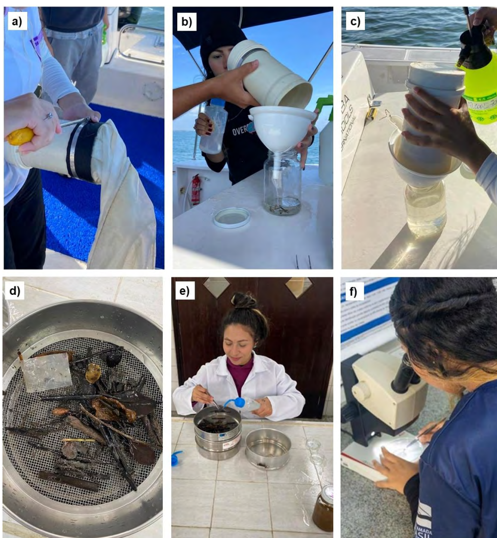
Figura 13: a) remoção do copo com a amostra arrastada localizada na porção final da rede; b, c) lavagem do copo e armazenamento da amostra em vidro com álcool 70°; d) disposição da amostra em peneira granulométrica de 1 mm; e) lavagem dos detritos orgânicos sobre a peneira para remoção de possíveis itens de microplástico fixados em folhas e/ou galhos; f) visualização dos itens encontrados macroscopicamente no microscópio estereoscópico
