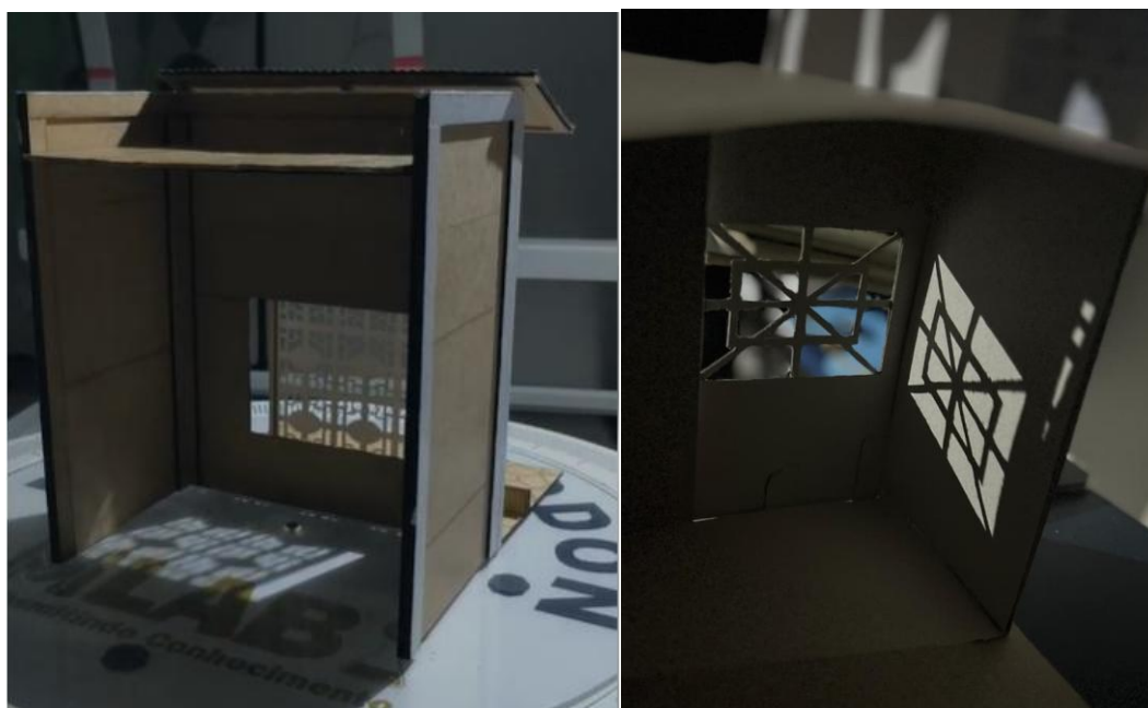
Figura 03: Maquetes da estratégia bioclimática cobogó e muxarabi, respectivamente.
