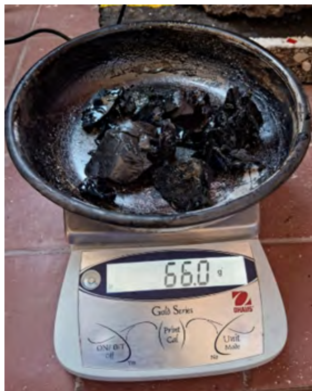
Figura 6: Pesado del asfalto PEN 85/100 para la Muestra 1.
