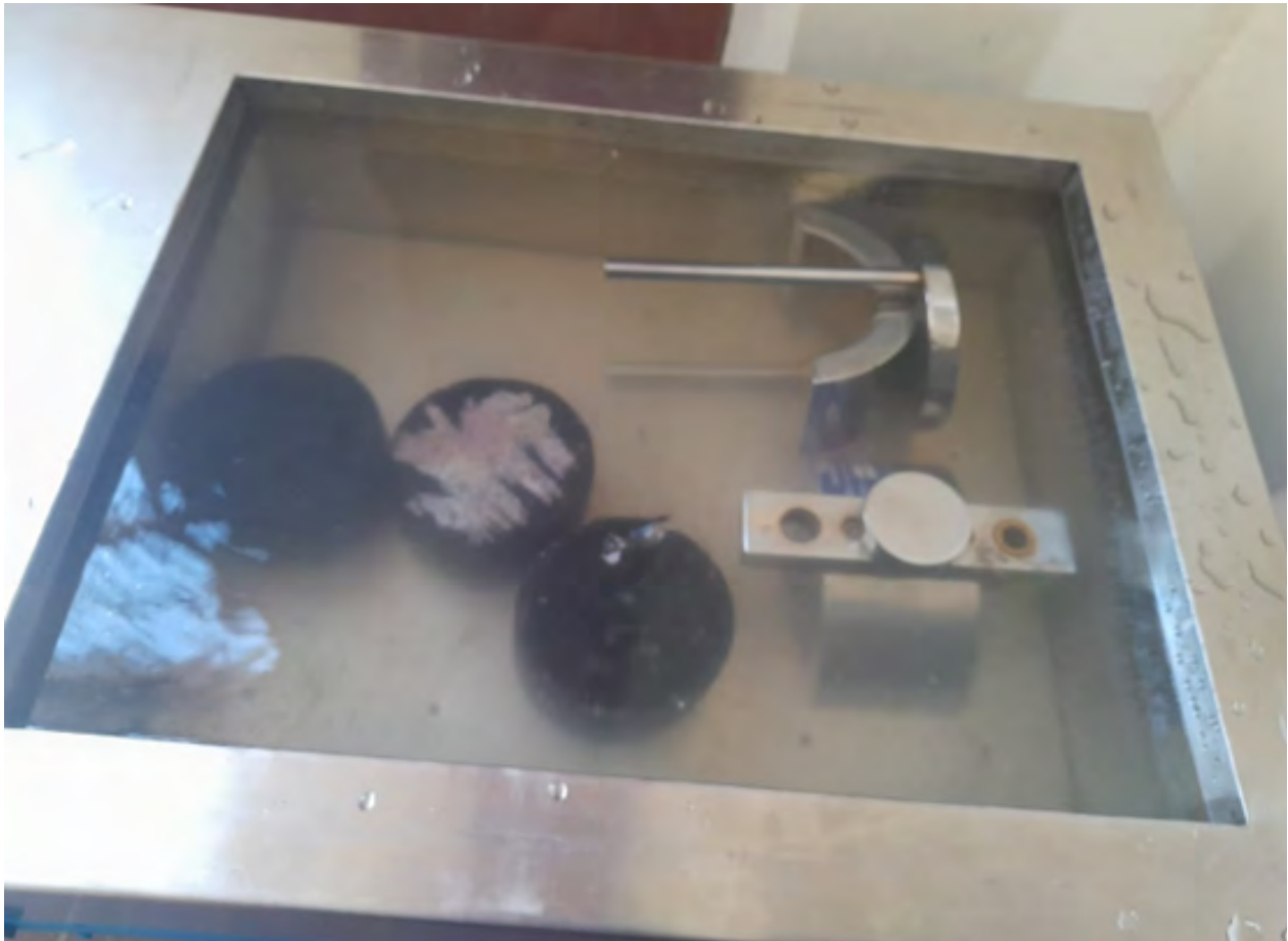
Figura 43: Sumersión de las probetas de las tres muestras preparadas a diferentes temperaturas, 125° C, 145° C y 185°, al Baño María, previamente calentado a 60 °C, durante 40 minutos.
