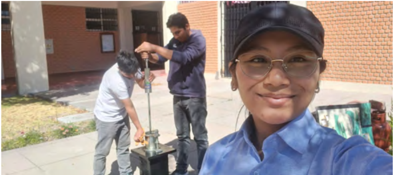
Figura 31: Compactación de 75 golpes por cara empleando el martillo de compactación Marshall.
