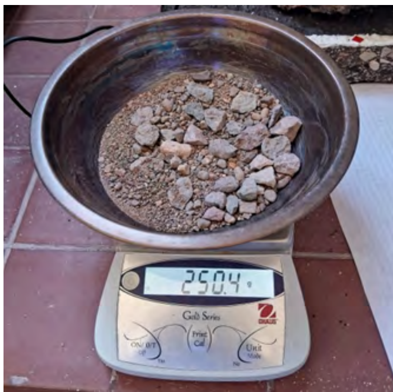
Figura 20: 3 muestras de 250 g de la combinación de los componentes de las Muestras 4, 5 y 6.
