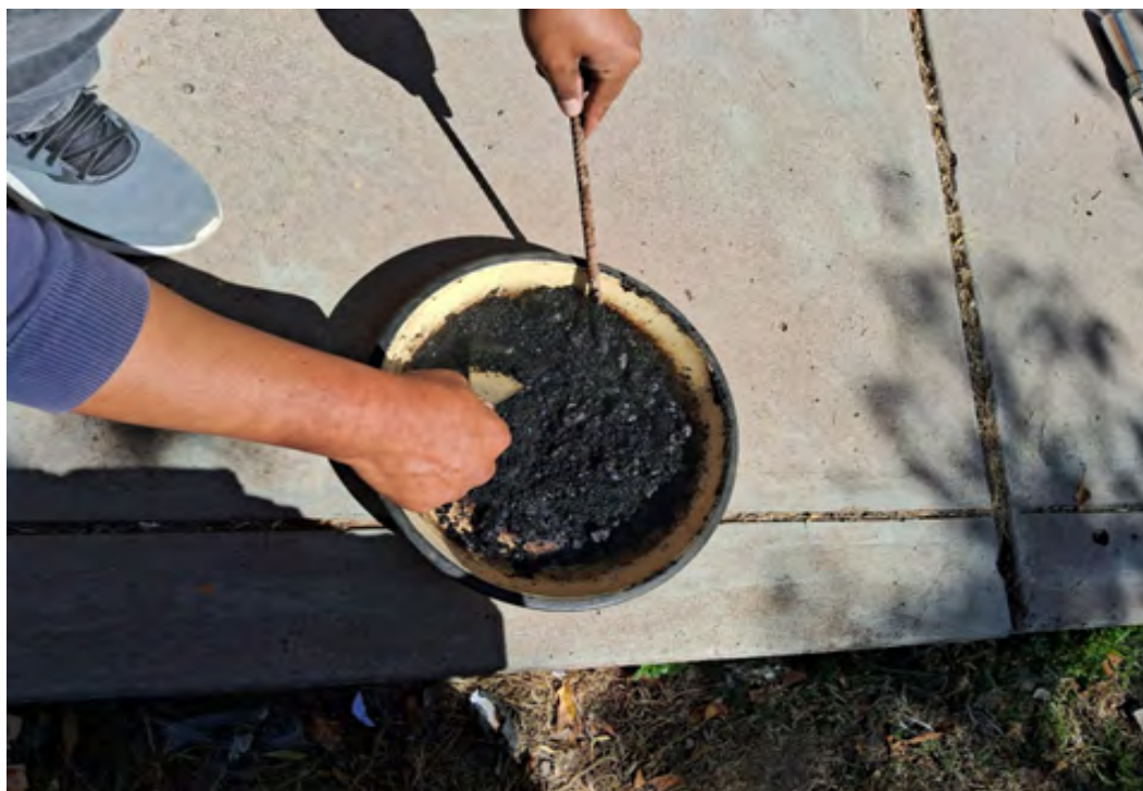
Figura 27: Mezclado homogéneo de los componentes de la muestra para la briqueta 2, a una temperatura controlada de 145 °C, con la ayuda de un termómetro de laboratorio, tazones de acero, espátulas y guantes.
