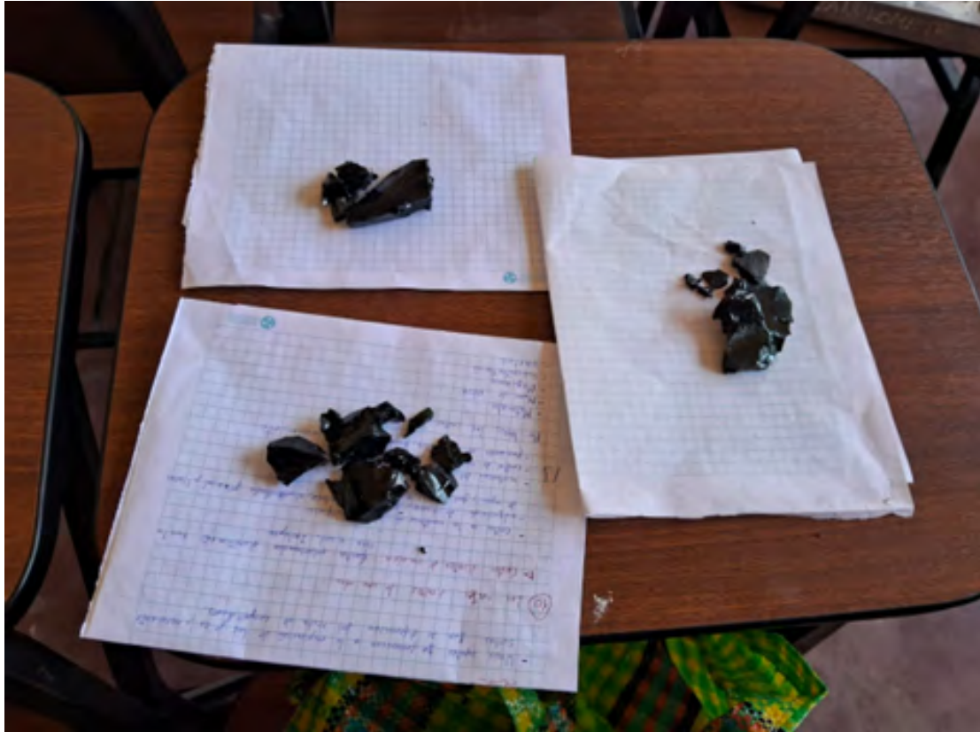
Figura 21: Pesado de 13.75 g de asfalto PEN 85/100 para las Muestras 4,5 y 6.
