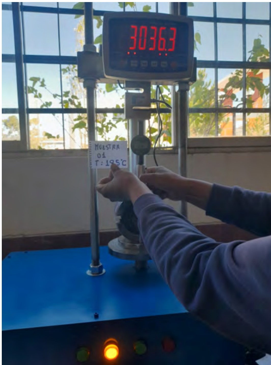
Figura 46: Carga máxima que soporta la probeta 1, medida en kg*f, preparado a una temperatura de 185° C.
