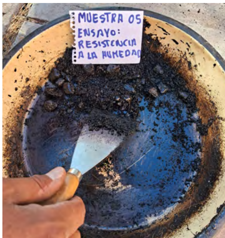
Figura 37: Acondicionamiento térmico y mezclado homogéneo de los componentes de la muestra representativa de 250 g de la muestra 5, a una temperatura controlada de 125 °C.
