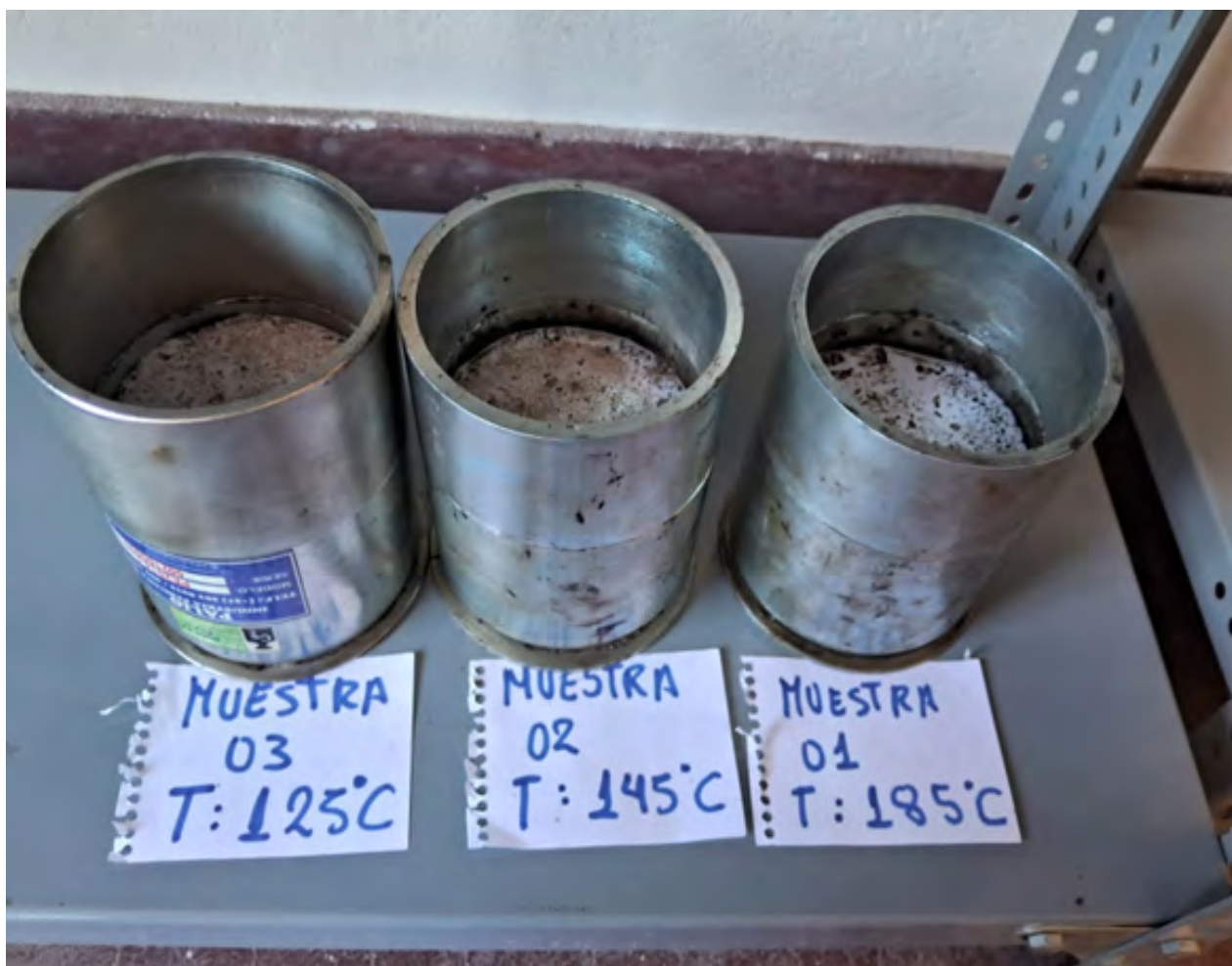
Figura 32: Reposo durante un período de 24 horas a temperatura ambiente de las briquetas 1, 2 y 3, en sus respectivos moldes de acero.
