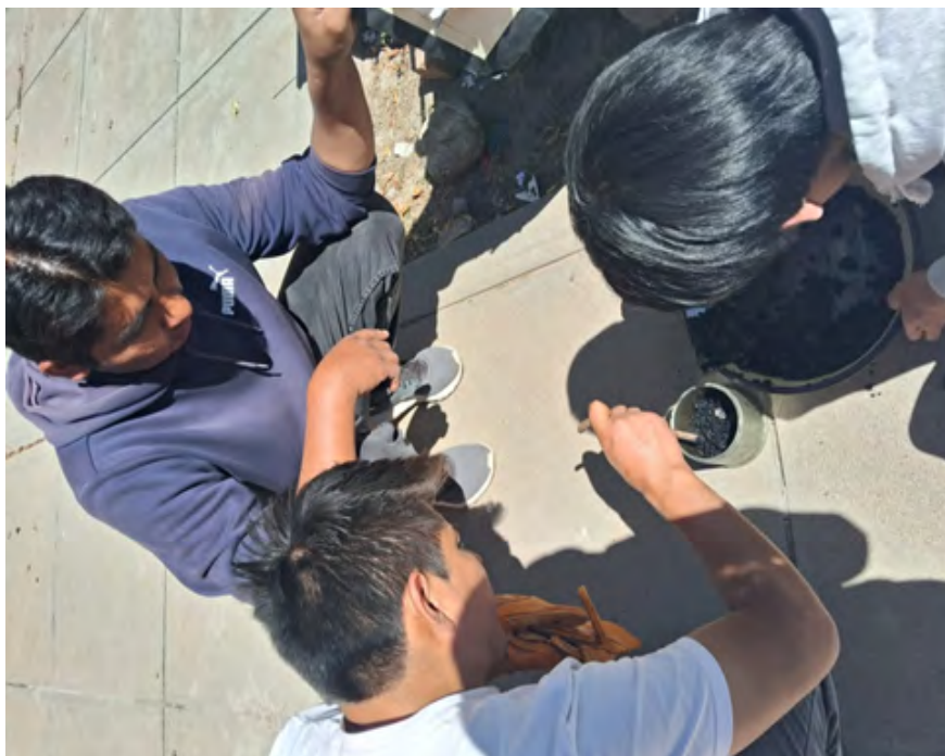
Figura 24: La mezcla asfáltica, previamente calentada y homogeneizada, se vierte cuidadosamente en el molde metálico cilíndrico previamente tratado con agente desmoldante, petróleo, para evitar adherencias
