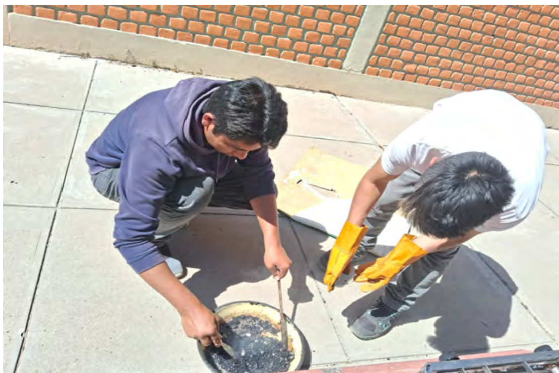
Figura 30: Mezclado homogéneo de los componentes de la muestra para la briqueta 3, a una temperatura controlada de 125 °C, con la ayuda de un termómetro de laboratorio, tazones de acero, espátulas y guantes.
