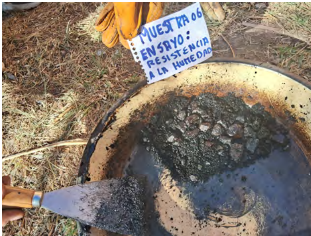
Figura 39: Acondicionamiento térmico y mezclado homogéneo de los componentes de la muestra representativa de 250 g de la muestra 6, a una temperatura controlada de 185 °C.
