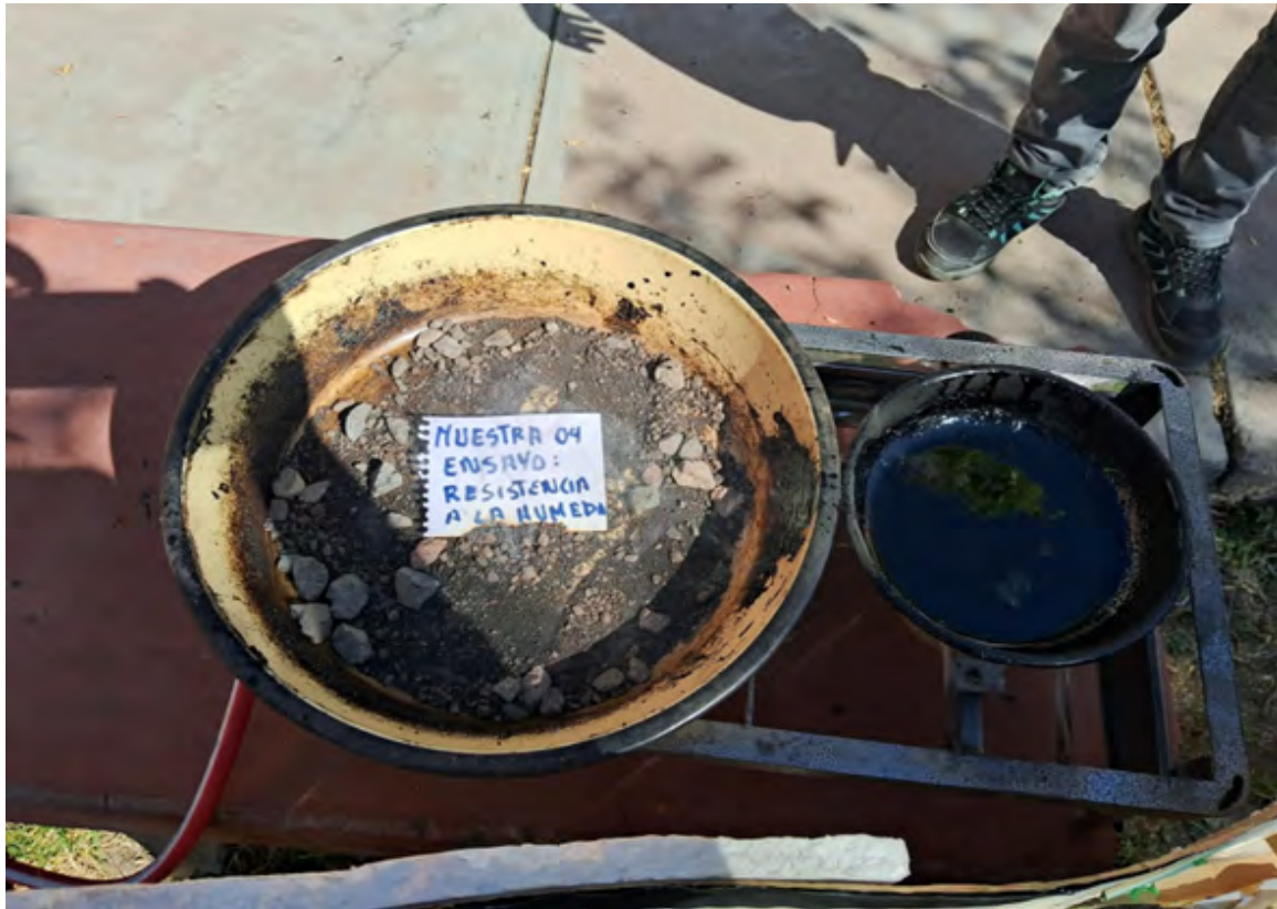
Figura 33: Acondicionamiento térmico y mezclado homogéneo de los componentes de la muestra representativa de 250 g de la muestra 4, a una temperatura controlada de 145 °C.
