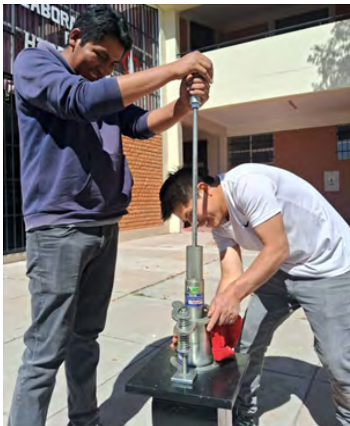
Figura 28: Compactación de 75 golpes por cara empleando el martillo de compactación Marshall.
