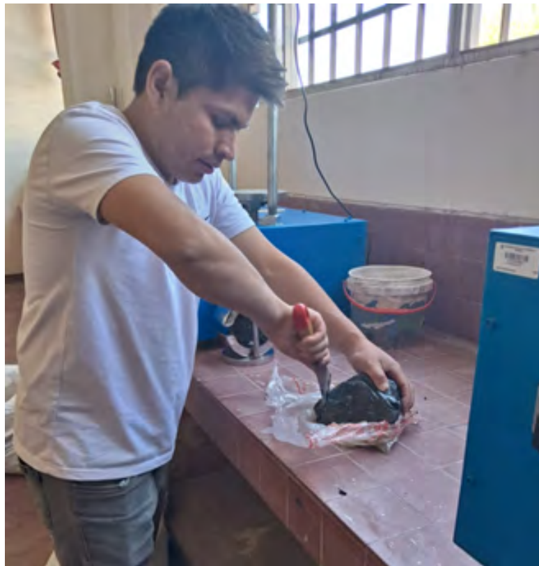
Figura 5: Preparación y fraccionamiento de asfalto en proporciones para las muestras correspondientes.
