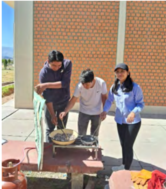
Figura 23: Acondicionamiento térmico y mezclado homogéneo de los componentes de la muestra para la briqueta 1, a una temperatura controlada de 185 °C, con la ayuda de un termómetro de laboratorio, tazones de acero, espátulas y guantes.
