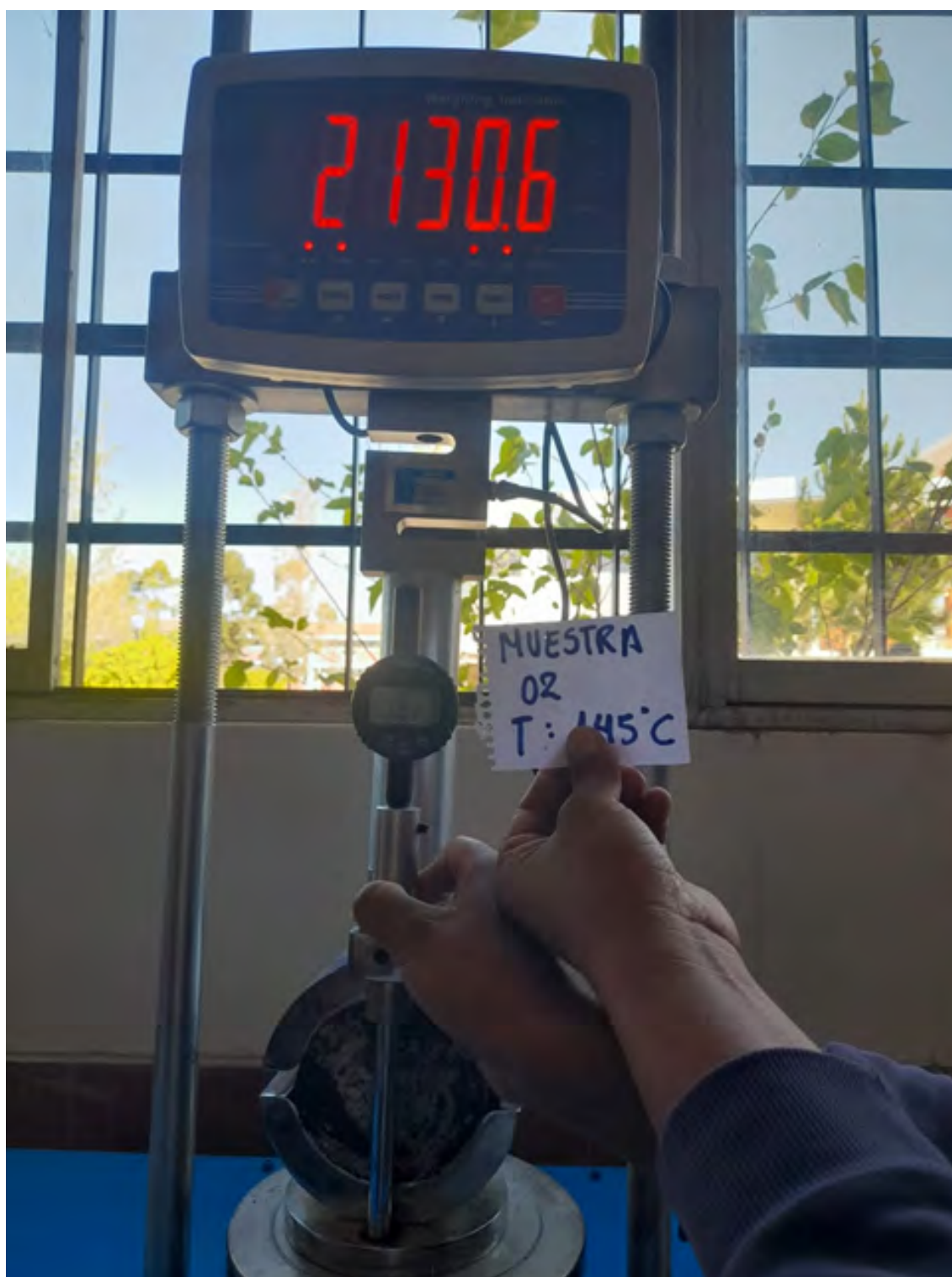
Figura 45: Proceso de ensayo de estabilidad Marshall de la probeta 2, cuya carga máxima que soportó fue de 4150.2 kg*f, preparado a una temperatura de 145° C.
