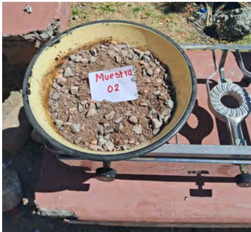
Figura 26: Secado y calentamiento de los componentes pétreos de la muestra para la briqueta 2, a una temperatura controlada de 145 °C.
