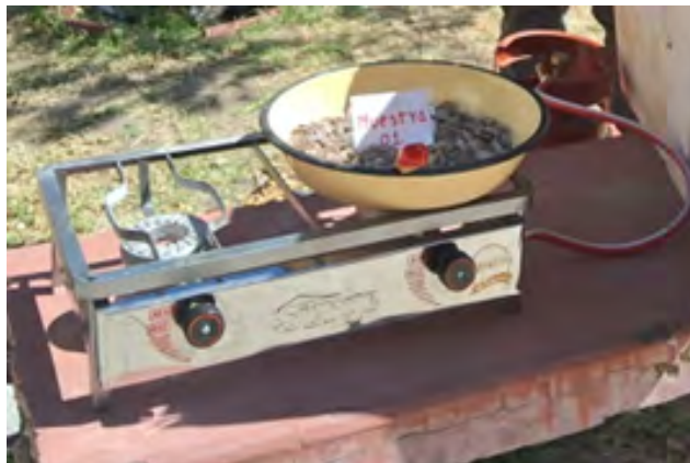
Figura 22: Secado y calentamiento de los componentes pétreos de la muestra para la briqueta 1, a una temperatura controlada de 185 °C.
