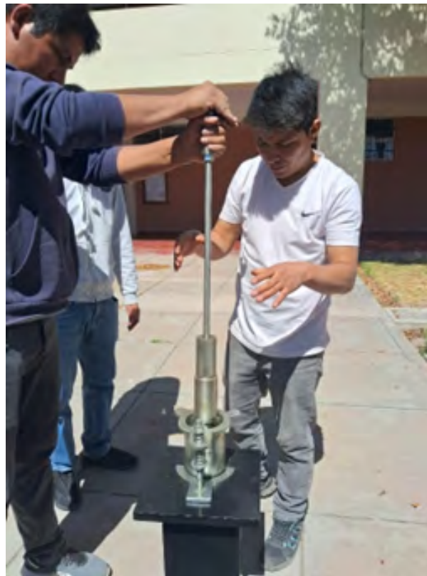
Figura 25: Compactación de 75 golpes por cara empleando el martillo de compactación Marshall.
