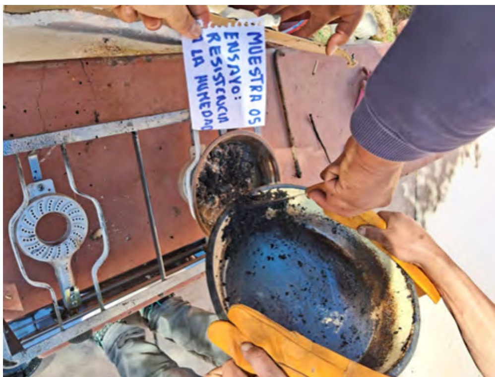
Figura 38: Se añade la mezcla homogénea, mezclada a 125° C, una vez enfriada a los 85°C, al agua hirviendo.
