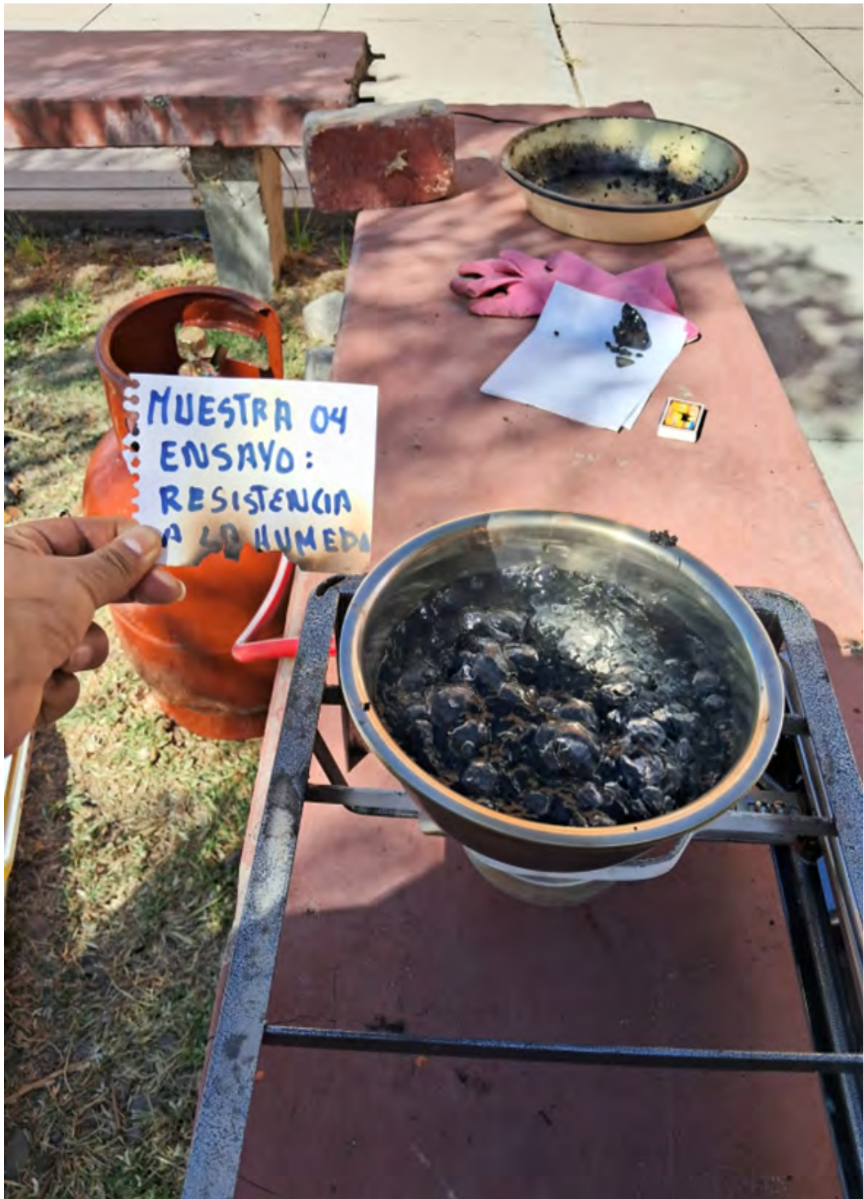
Figura 36: Se deja hirviendo junto a la mezcla asfáltica durante 10 minutos.
