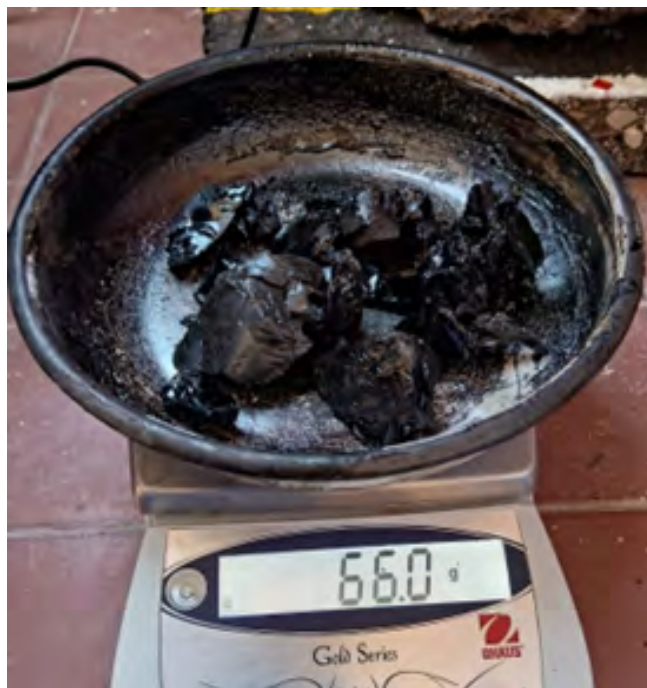
Figura 11: Pesado del asfalto PEN 85/100 para la Muestra 2.
