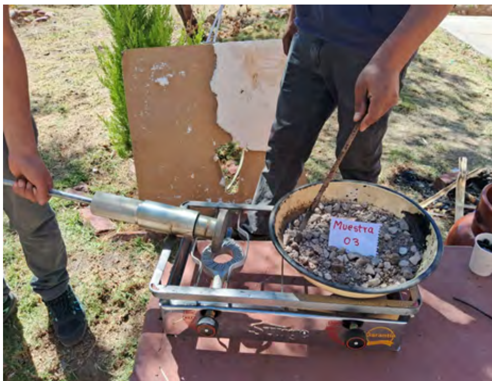
Figura 29: Secado y calentamiento de los componentes pétreos de la muestra para la briqueta 3, a una temperatura controlada de 125 ° C.
