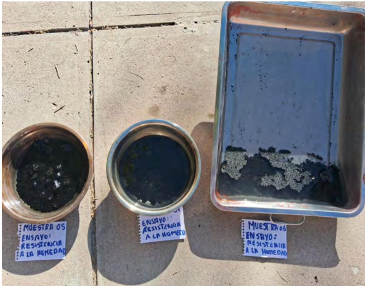
Figura 47: Condiciones finales de la resistencia de la adhesión entre el ligante asfáltico y el agregado frente a la acción del agua, a 3 temperatura de mezclado, 125° C, 145° C y 185° C para su análisis y evaluación.
