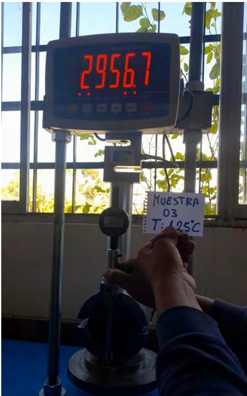
Figura 44: Carga máxima que soporta la probeta 3, medida en kg*f, preparado a una temperatura de 125° C.
