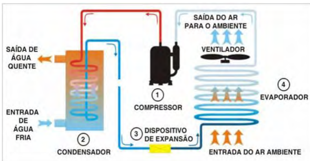
Figura 2 – Esquema de funcionamento de uma bomba de calor para aquecimento de água.
