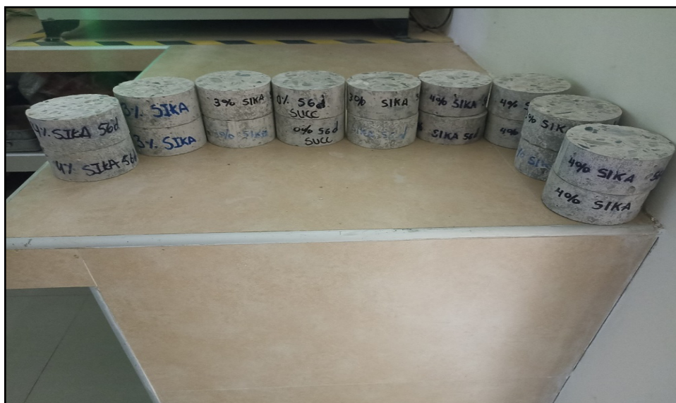
Figura 2 – Muestras cilíndricas para los ensayos de porosidad y succión capilar
