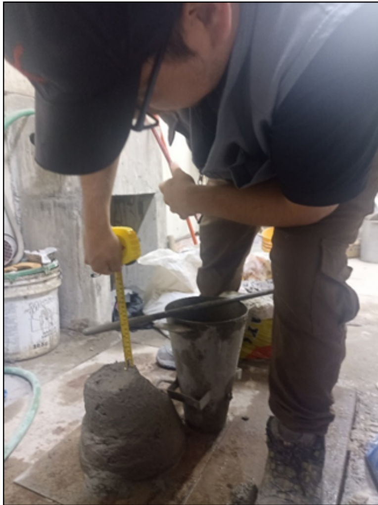
Figura 3 – Medición del asentamiento del concreto en estado fresco (SLUMP)
