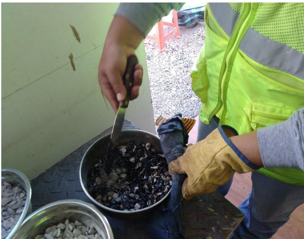
Figura 11: Preparación de las muestras de la mezcla asfáltica SMA
